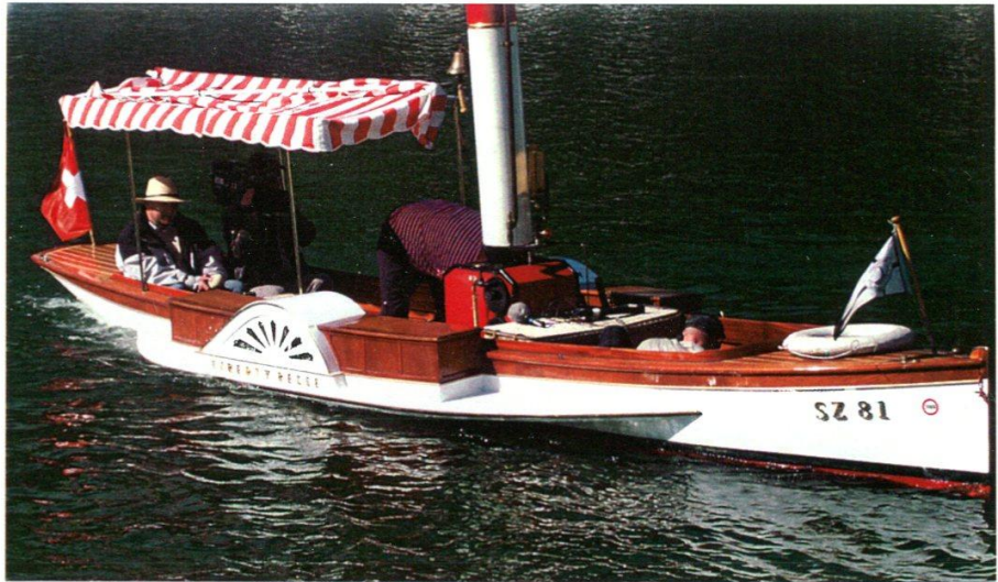
Die „Liberty Belle“ kommt vom Vierwaldstätter See. Der Rumpf wurde 1987 in Sperrholz gebaut, seine Länge misst 7,45 Meter. Angetrieben werden die beweglichen Schaufräder von einer Zwillingmaschine mit 2,5 PS. Beheizt wird der Kessel mit Öl.
