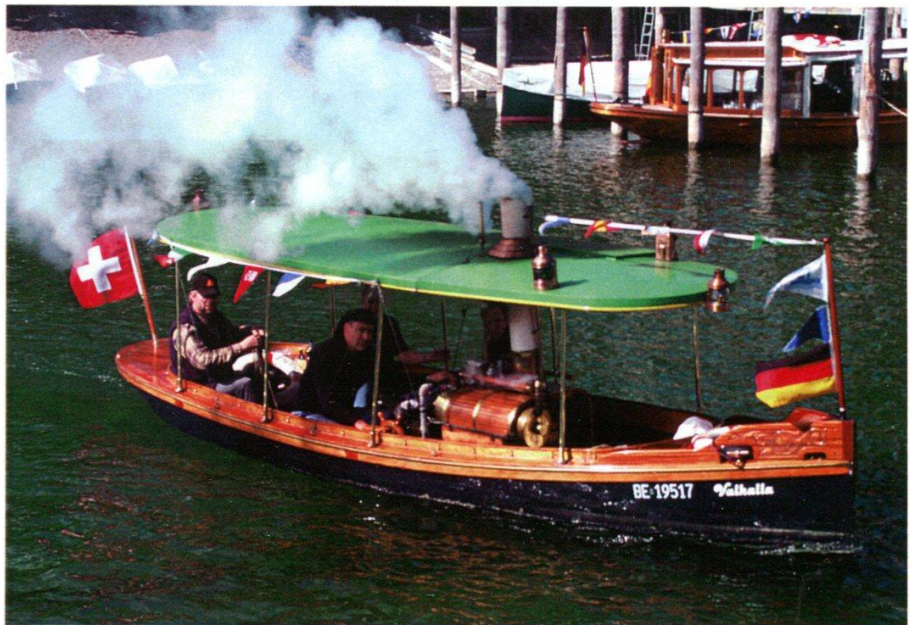
Die „Valhalla“ stammt vom Brienzer See. Ihre GfK-Schale wurde 1986 gebaut. Die Länge des Rumpfes beträgt 6,30 Meter. Der Wasserrohrkessel mit Holz- und Kohlefeuerung ist das Herz der Zwillingmaschine. Ihre 7,5 PS beschleunigen das Boot auf rund 8 Knoten.
